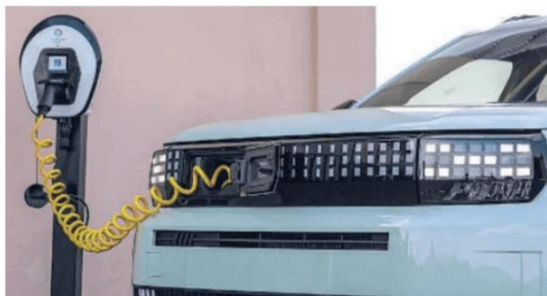
La parte delantera tiene un cable extraíble para recarga lenta
